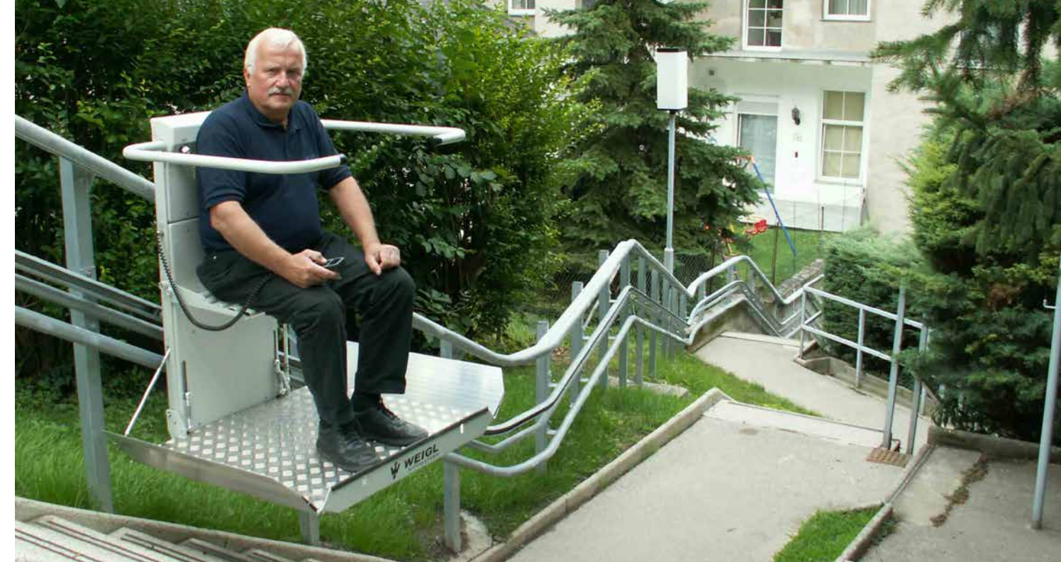
L'azionamento senza batteria consente di effettuare percorsi lunghi anche in impianti esterni.
